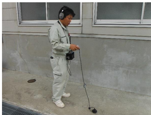
漏水探知機による漏水調査
