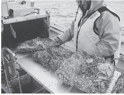
〈ホタテガイ養殖残渣の削減とホタテガイの成長に効果がある洋上ホタテかご洗浄機〉
