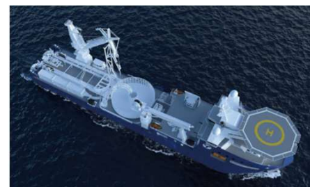
ケーブル敷設モード
