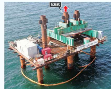
TLP式浮体係留基礎の現地実験 (左 : 石狩湾新港、右 : 石狩湾沖(水深約100m))
