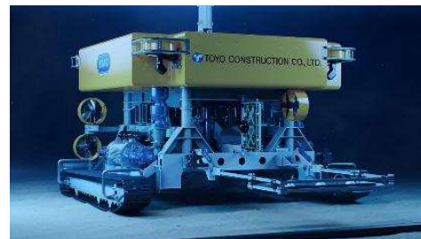
埋設機操作トレーニング(イメージ)
