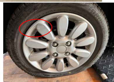
左前輪タイヤのパンク及びホイール損傷
