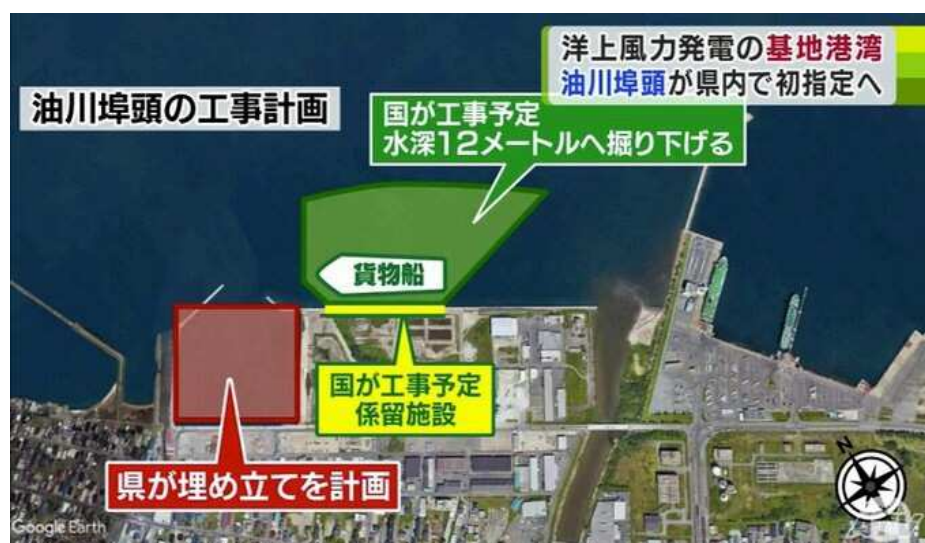
図－９ 油川埠頭の工事計画（国土交通省事業と県事業）（ＴＢＳニュースより）
