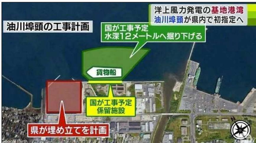
油川埠頭の工事計画である。国は水深12メートルに掘り下げる工事をしており県は埋め立て工事の予定である。これらの工事により国際物流ターミナルと洋上風力基地が形成される。
