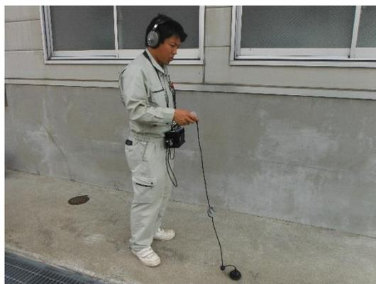
漏水探知機による漏水調査
