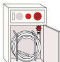
屋内消火栓設備
