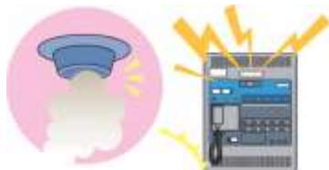
自動火災報知設備
