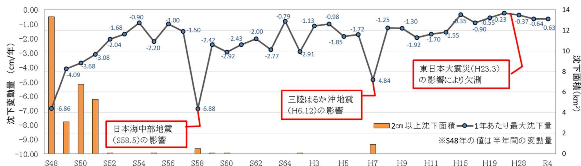
図 3-54 地盤沈下観測水準測量（最大沈下量経年変化）
